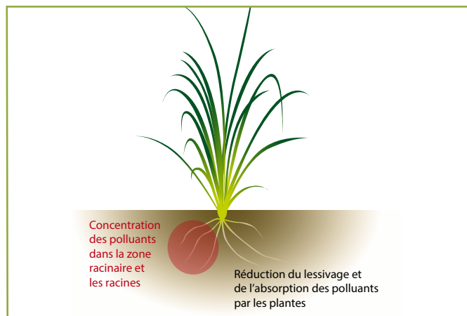
Figure 4 : Schéma de fonctionnement de la phytostabilisation
