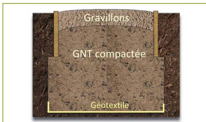
Figure 26 : Schéma de principe d'un revêtement gravillonné (Dessin de C. Houel)
