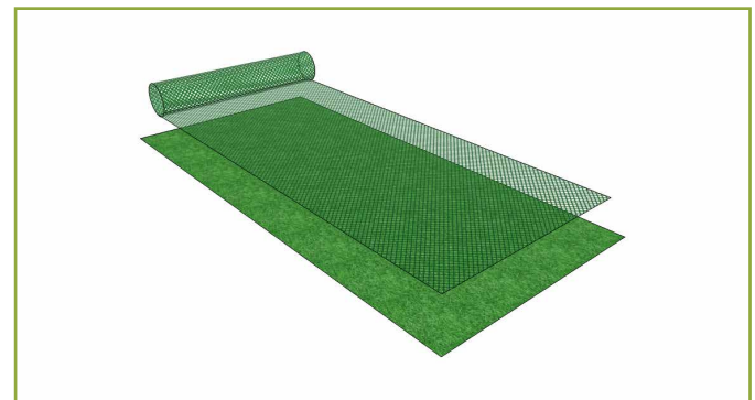
Figure 28 : Schéma d'application d'un maillage en renforcement sur gazon en place (Dessin de C. Houel)
