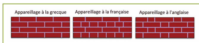
Figure 13 : Schéma de principe des appareillages à la française, à l'anglaise et à la grecque (Dessin de Cédric Houel)
