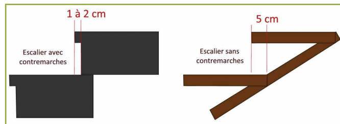
Figure 51 : Schéma des règles de dimensionnement de nez-de-marche (Dessin de Cédric Houel)
