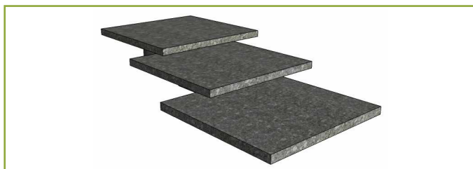
Figure 7 : Schéma d'un escalier en dalles palières (Dessin de Cédric Houel)
