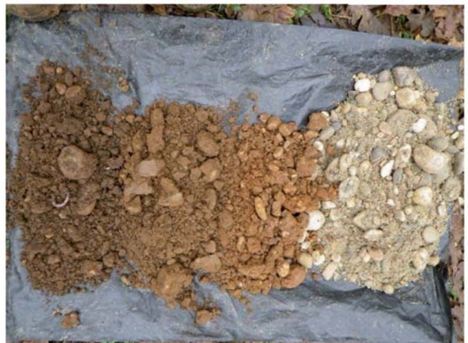
♦ P006 : Détail des matériaux composant les horizons
